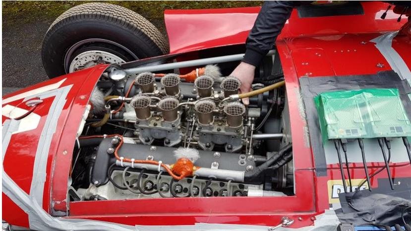
À droite, deux récepteurs Sennheiser EK 6042 montés sur la Lancia-Ferrari D50A, recevant l'audio de micros à grand diaphragme rendus sans fil par des émetteurs enfichables SKP.
